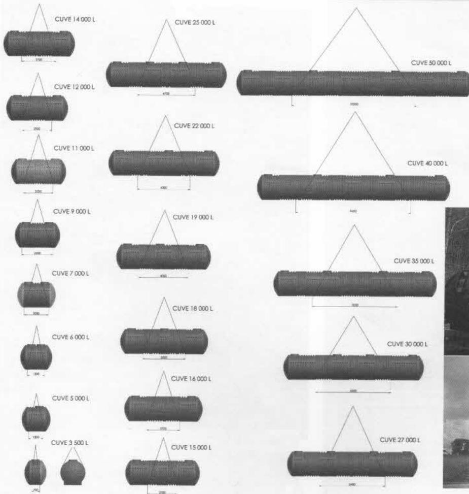
Elingage obligatoire pour soulever tout appareil DP aussi bien avec l'aide d'une grue de levage, qu'avec l'aide d'un palan et selon les schémas ci-contre pour une prise parfaite et équilibrée.
