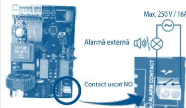
Opțiunea de externalizare a semnalului de alarmă. Contact uscat (fără tensiune) normal deschis (NO) acționat de un releu.
