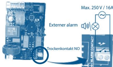
Option eines externen Alarms potentialfreier Kontakt (keine Spannung) NO (normal open) betätigt durch ein Relais mit max. 250V/16A
