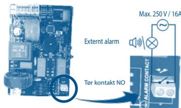
Mulighed for at gøre alarmsignalet eksternt. Tør kontakt (ingen spænding) NO (normalt åben) drevet af et max. 250V/16A relæ.
