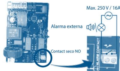
Posibilidad de externalizar la señal de alarma. Contacto seco (sin tensión) NO (normalmente abierto) accionado por un relé.
