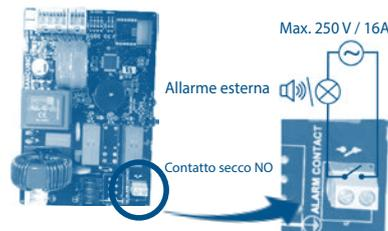
Opzione di esternalizzazione del segnale d'allarme. Contatto secco (senza tensione) NO (normally open) attuato da un relè.
