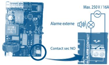
Possibilité d'externaliser le signal d'alarme. Contact sec (pas de voltage) NO (normalement ouvert) actionné par un relais.
