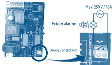
Mogelijkheid om het alarmsignaal extern te maken. Droogcontact (geen voltage) NO (normaal open) werkzaam bij maximaal 250V/16A relais.
