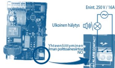
Hälytyssignaalin ulkoistusvaihtoehto. Yhteenliittymisen ilman polttoainesiirtoa (ei jännitettä), tavallisesti avoinna (NO I. normally open), toimii enint. 250 V:n / 16 A:n releellä.
