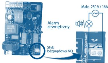
Opcja wyprowadzenia na zewnątrz sygnału alarmowego. Styk bezprądowy (bez napięcia NO (normalnie otwarty) uruchamiany przez przekaźnik.
