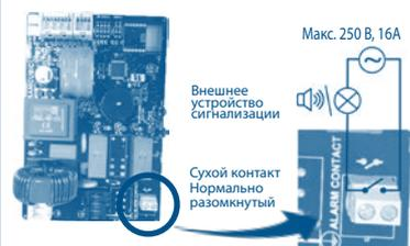
Сигнал тревоги можно передать на внешний подряд. Такие модели оснащены сухим (беспотенциальным) нормально разомкнутым контактом, которым можно управлять с помощью реле. Контакт сигнализации может быть подключен к системе,
