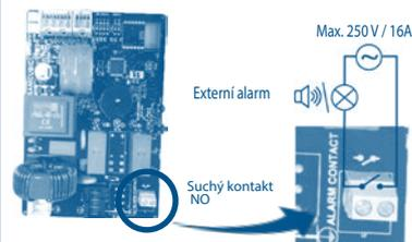
Možnost externího poplašného zařízení. Suchý kontakt (bez napětí) NO (normálně otevřený) ovládaný relé.
